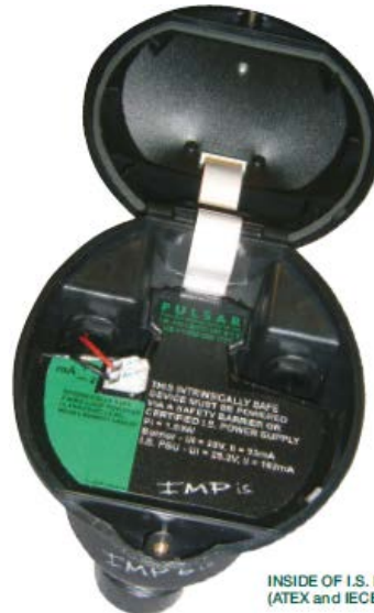
تصویر داخل IMP I.S. خروجی جریان و مناسب برای محیط خطرناک
