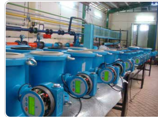
خط تولید فلومترهای سری مگاب ۳۰۰۰
